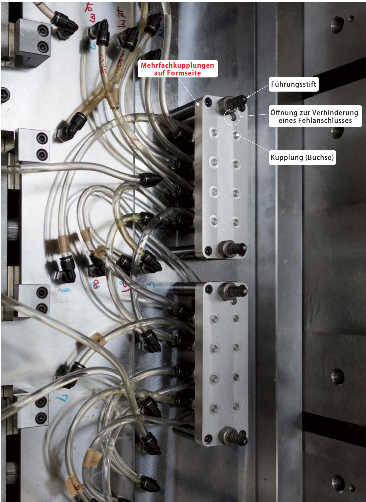
8,500kN (850 t) SGM 8 Anschlüsse × 2 Für die Formtemperaturregelung
